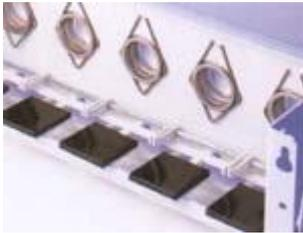
Die lasergeschnittenen Trefferklappen, die jeden Treffer sofort sichtbar machen, gewährleisten hochpräzises und absolut gleichmäßiges Kippverhalten. Die Aufprallflächen sind durch verschleißfreie schwarze Kunststoffplatten zuverlässig vor Bleiablagerungen und Ausbeulen geschützt. Über ein 12 m langes Zugseil stellt der Schütze die Klappen wieder auf.
